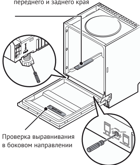
Проверка выравнивания переднего и заднего края
